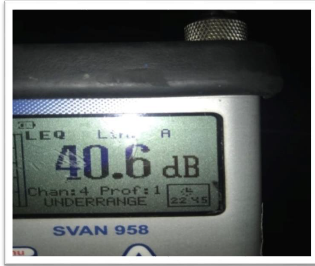
Şekil 10.7 Türbin Çalışmadığı Zaman Ölçüm Değeri L_N = 40.6 \text{ dB}
