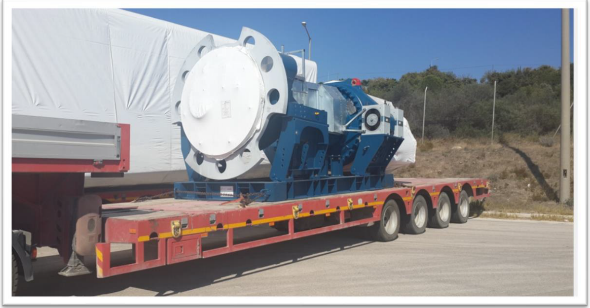
Şekil 6.34 Drive Train Nakliyesi
